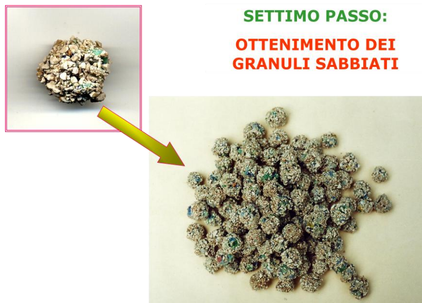
Fig. 15 – Ottenimento dell’alPET-s a seguito del raffreddamento dei granuli.
