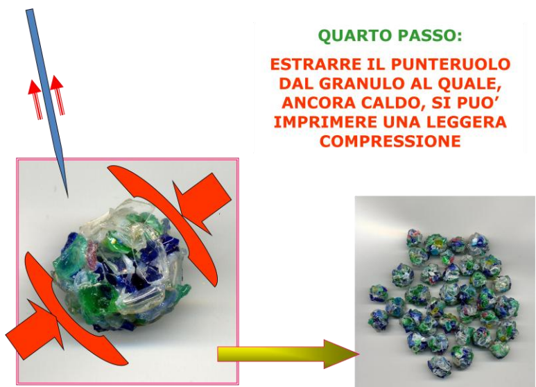
Fig.13 – Possibilità di imprimere pressioni al granulo ancora caldo.
