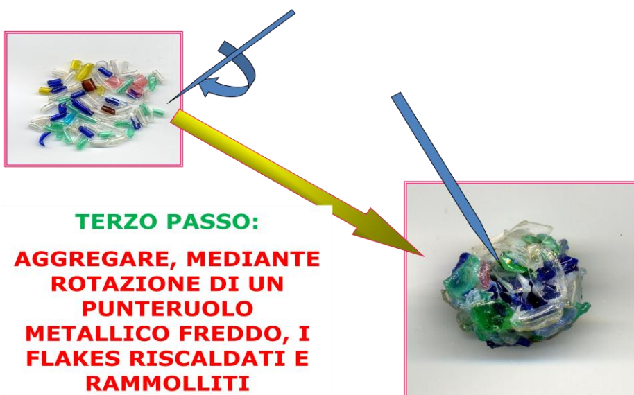
Fig. 12 – Collaggio dei flakes mediante rotazione forzata.
