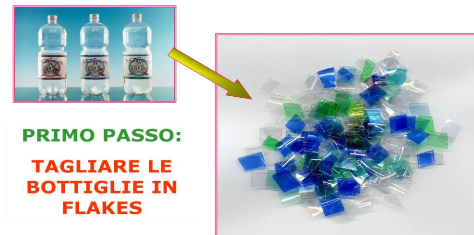
Fig. 10 – Taglio delle bottiglie di PET in Flakes.
