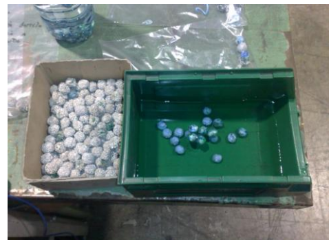
Fig. 8 – Aggregato, sia rivestito che non rivestito di sabbia, prodotto dalla macchina
