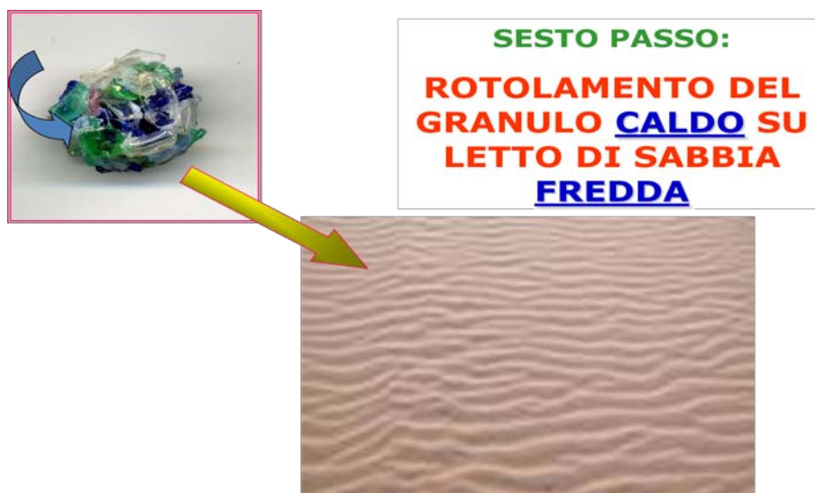
Fig. 13 – Sabbiatura dell’aggreto leggero artificiale di PET alPET
