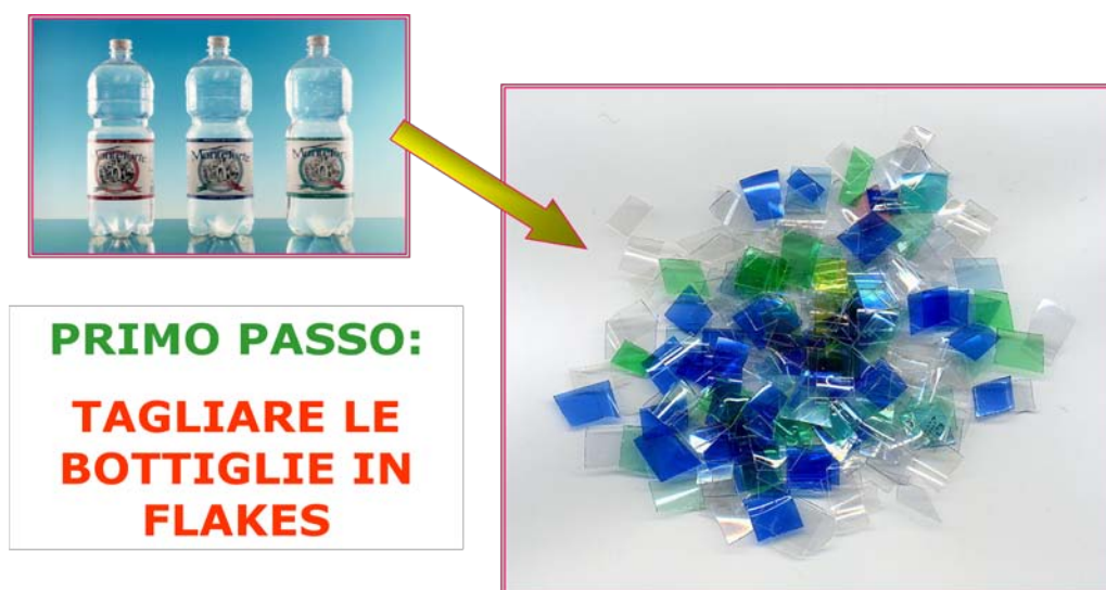
Fig. 9 – Taglio delle bottiglie di PET in Flakes.
