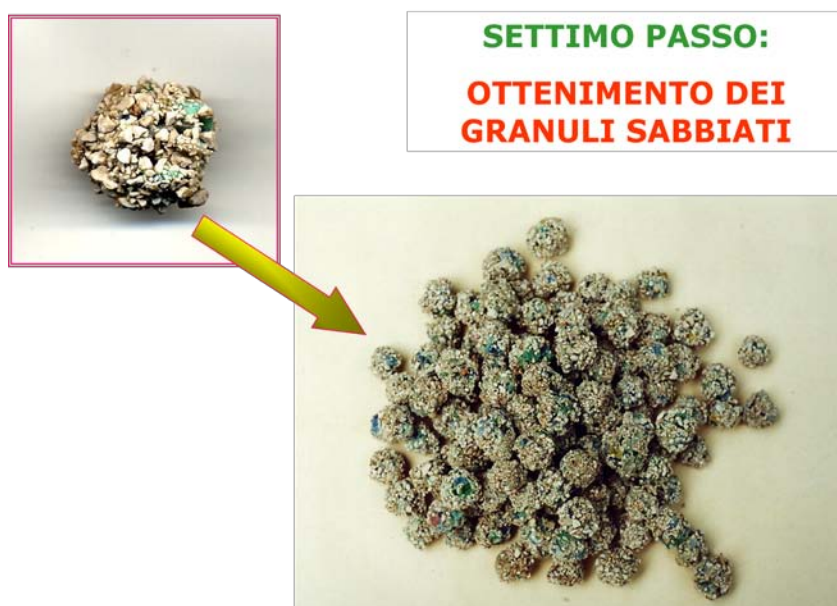
Fig. 14 – Ottenimento dell’alPET-S a seguito del raffreddamento dei granuli.
