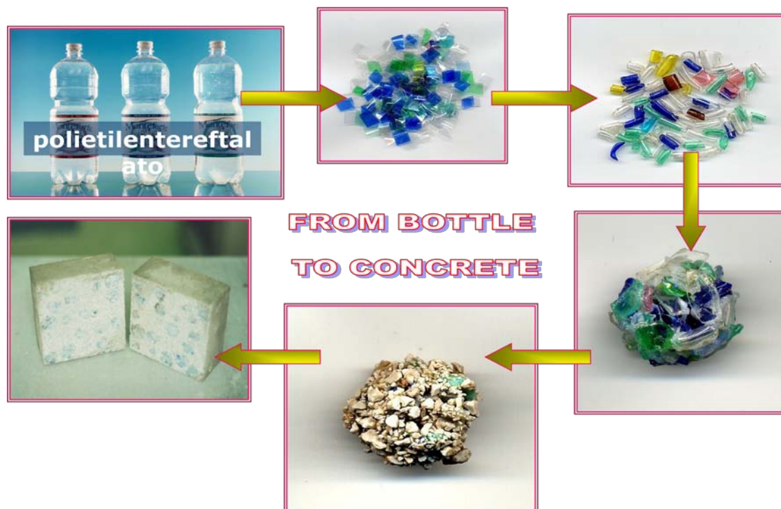
Fig. 8 – Schema di realizzazione dell'aggregato leggero artificiale alPET-S.
