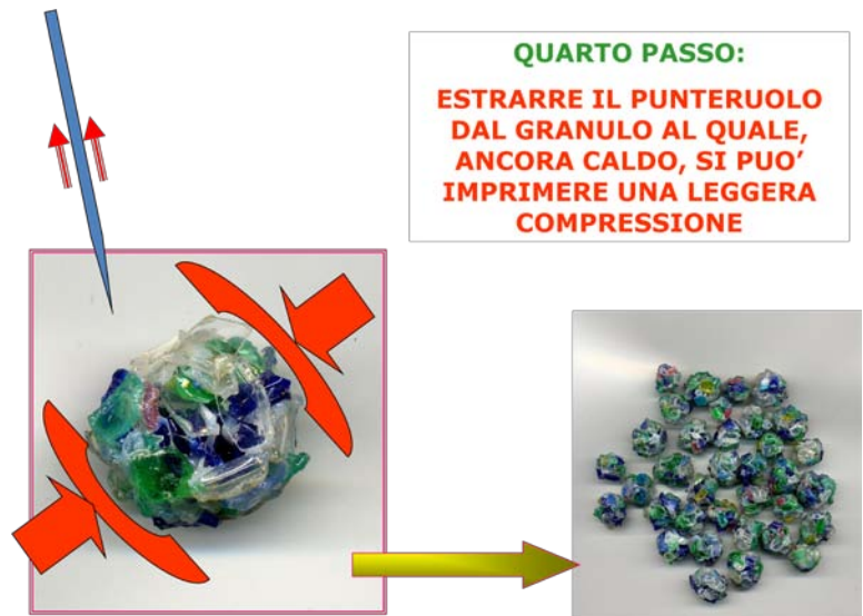
Fig.12 – Possibilità di imprimere pressioni al granulo ancora caldo.
