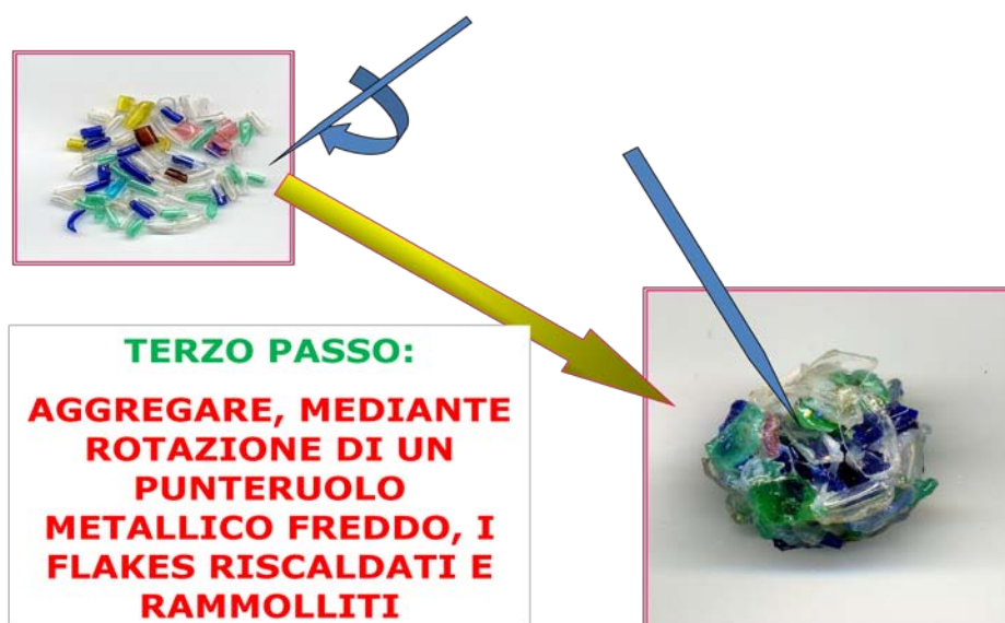
Fig. 11– Collaggio dei flakes mediante rotazione forzata.
